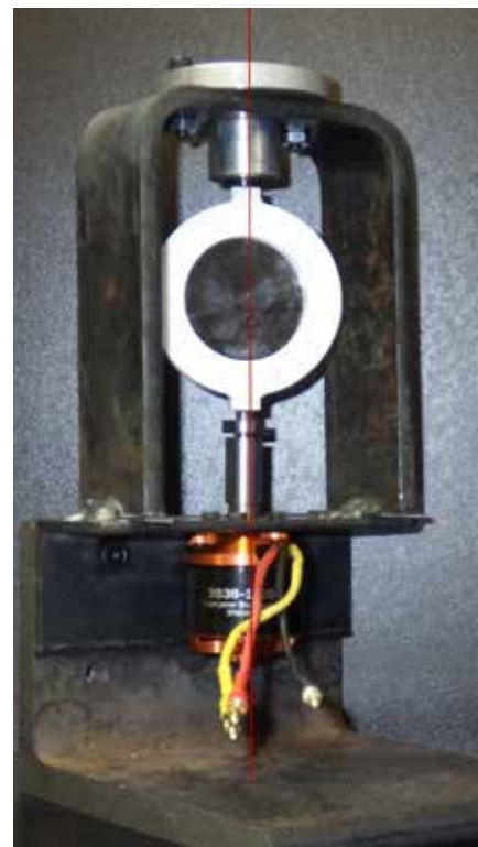
Figure 3 : Image du support à miroir tournant et à moteur. La ligne rouge représente l'axe de rotation du miroir. Source : Photo prise par Francis Leduc et Mailo Potvin.
