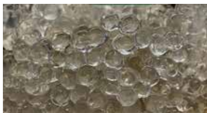
Figure 3 : Billes d'alginate formées par réaction entre alginate de sodium et ions calcium. Source : Abdalla L, Kone AO, Islam A. Billes d'alginate formées par réaction entre alginate de sodium et ions calcium [photographie prise avec un téléphone intelligent]. 2026
