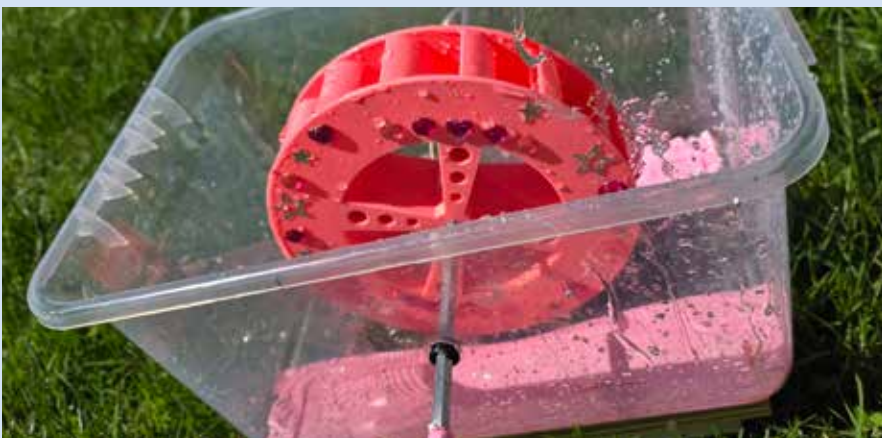
Figure 1 : Notre turbine rose, imprimée à l'aide d'une imprimante 3D. Source : Photo prise par Marika Pilon et Mariane Nolin.
