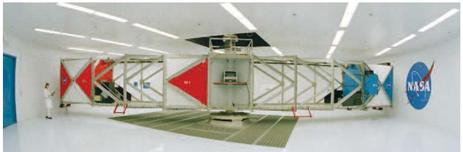
**FIGURE 2** Centrifugeuse « 20-G » de la NASA, au centre de recherche Ames, en Californie, où des tests sont conduits afin de simuler une force gravitationnelle pouvant atteindre 20 fois celle de la Terre.
