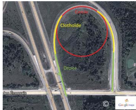
FIGURE 2 Représentation des segments « droite-clothoïde-cercle » sur une bretelle d'autoroute. Source : Google maps. [Consulté le 15 avril 2015]. Modifié par David Petitclerc le 15 avril 2015.
